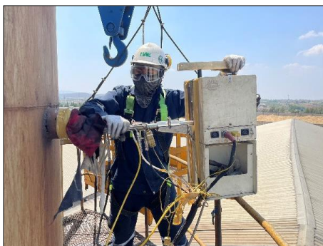
ภาพที่ 3.1-2 จุดตรวจวัดคุณภาพอากาศจากปล่องระบาย บริเวณปล่องระบายของหม้อไอน้ำ (120 ตัน)
